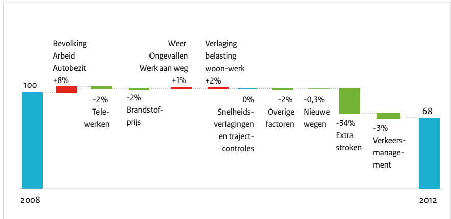
Figuur 6.4 Verklaring van de afname van het reistijdverlies op het hoofdwegennet, 2008-2012. Bron: KiM.
